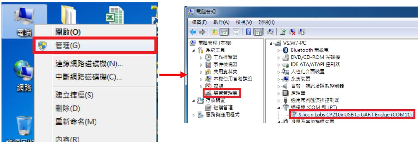
2. 接著開啟上傳程式 Data Read 將傳輸資訊選擇至 Cradle-IR、及模擬的 COM PORT、Baud Rate:115200 CPT-8000L 的部分則選至「2. 上傳檔案」，將盤點機放在傳輸座上，上傳完畢即完成。
